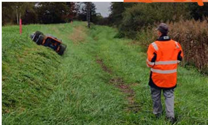
Le service a fait l'acquisition d'un robot permettant la tonte de flancs abrupts et de dévers. Télécommandé, électrique et d'une autonomie de 5h, ce matériel a nécessité un investissement de 46 000 € TTC.
